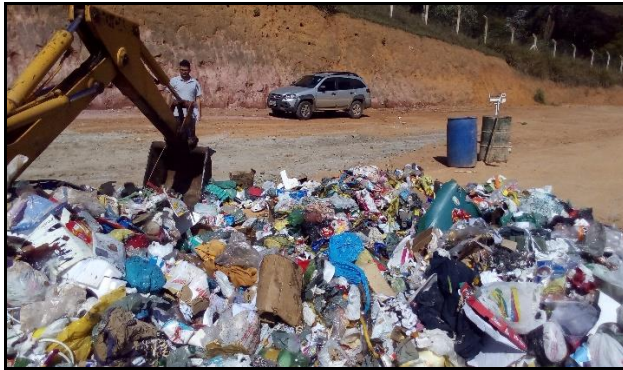
Figura 04: Homogeneização e quarteamento dos resíduos. Fonte: Saneamb Engenharia e Consultoria Ambiental LTDA, 2017.
