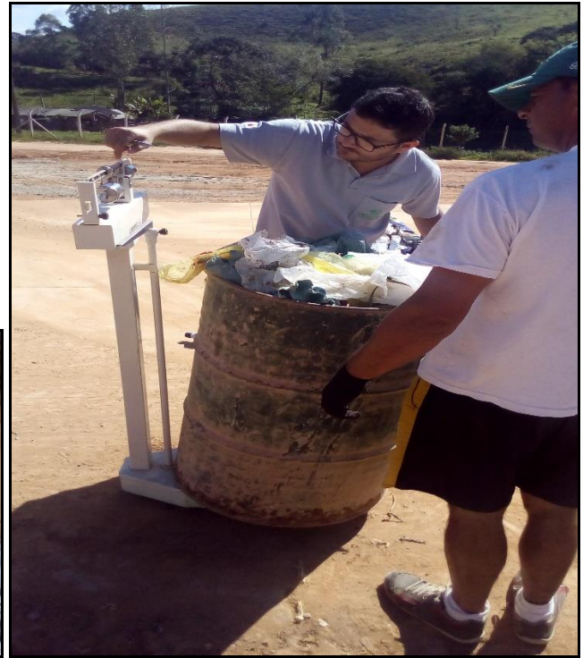
Figura 05: Pesagem da amostra quarteada – Tambor de 200 litros. Fonte: Saneamb Engenharia e Consultoria Ambiental LTDA, 2017.
